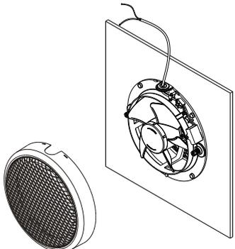
Ensamble la rejilla interior en la ventana o panel del extractor que va a instalar.
